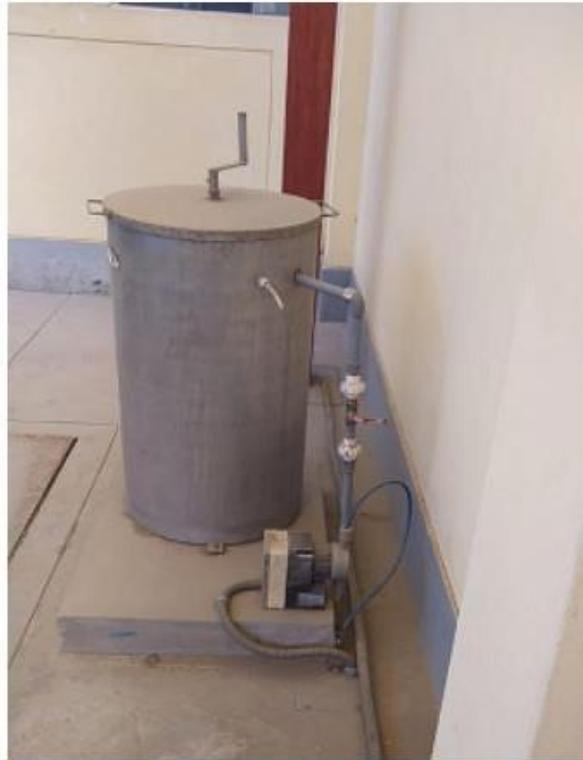
Fig. 3: Tanque de preparación de insumo químico
