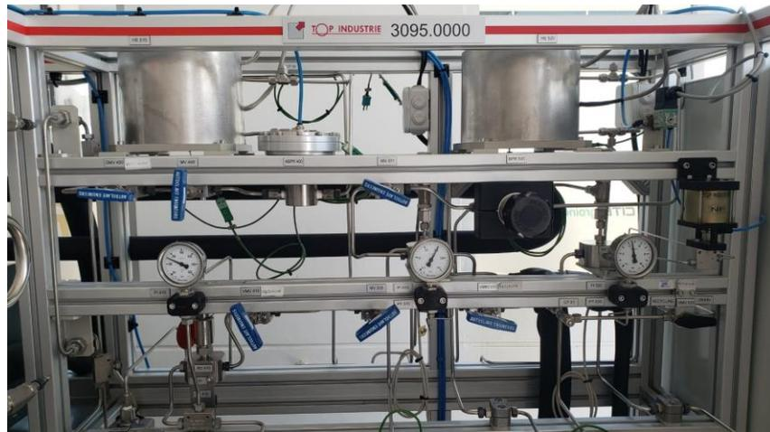
Conexiones y válvulas de CO<sub>2</sub>
