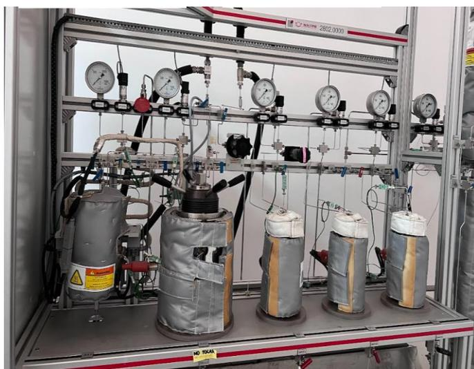
Conexiones y válvulas de CO2
