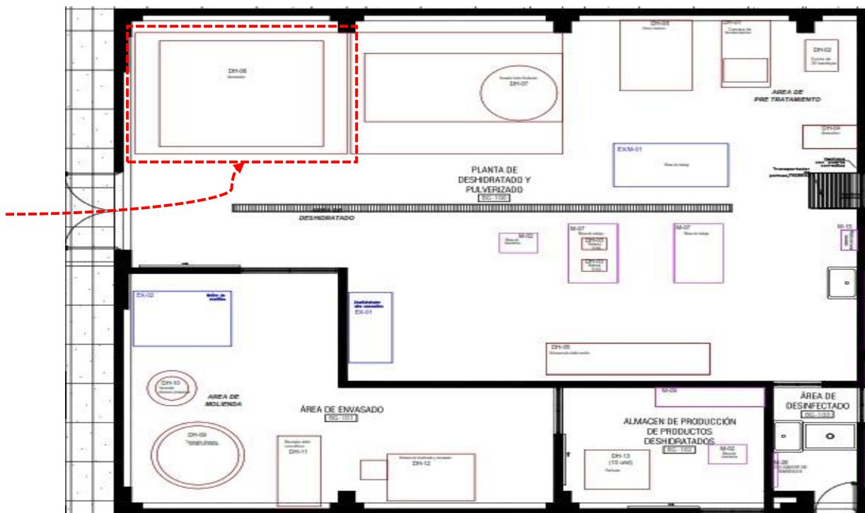
El equipo, requiere un traslado y su ubicación es dentro del recuadro en rojo, se requiere considerar todas las conexiones para su operación, en el ambiente contamos con (vapor, aire comprimido, gas, energía eléctrica)
